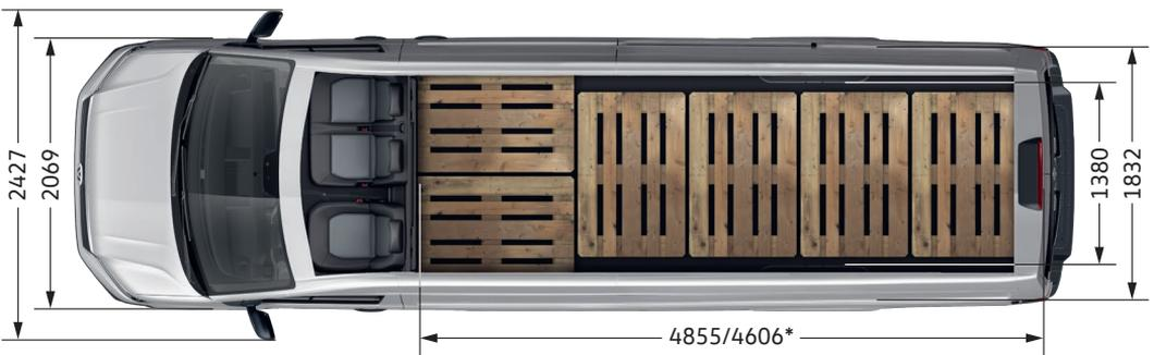
\*Laderaumlänge, max. (am Boden)/Laderaumlänge, min.
