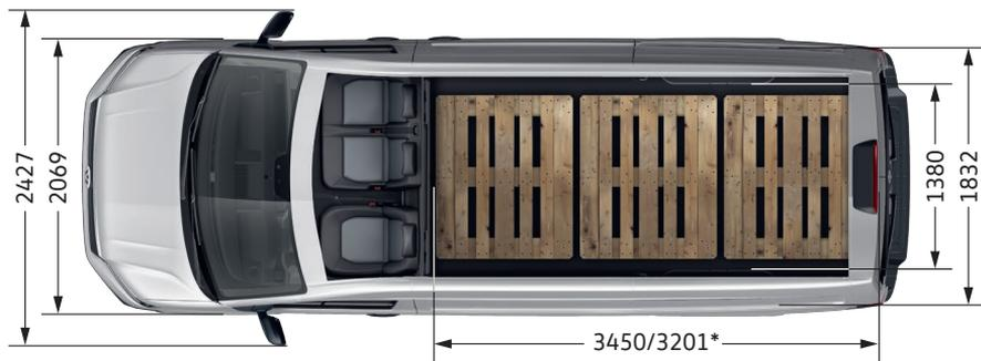
\*Laderaumlänge, max. (am Boden)/Laderaumlänge, min.
