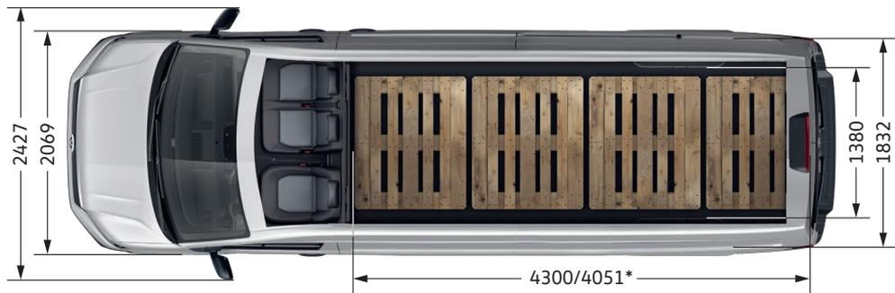
\*Laderaumlänge, max. (am Boden)/Laderaumlänge, min.
